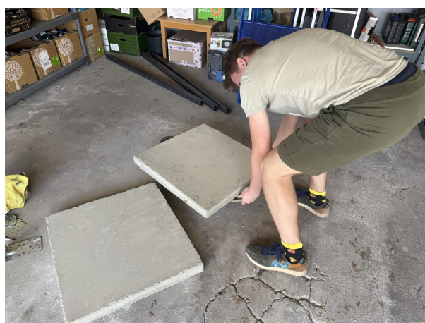
Przygotowanie betonowych elementów balastujących stanowisko testowe.
