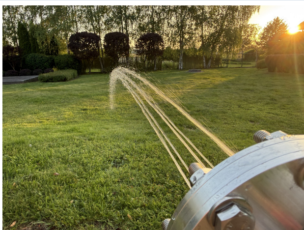
Test szczelności wtrysku po stronie paliwa.
