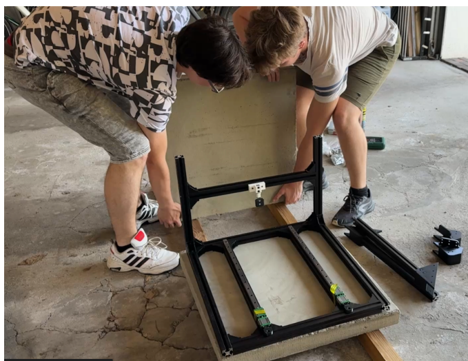
Składanie konstrukcji nośnej hamowni z profili i prowadnic.
