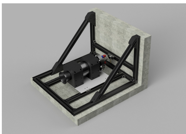
Model CAD hamowni i rozmieszczenie głównych elementów.
