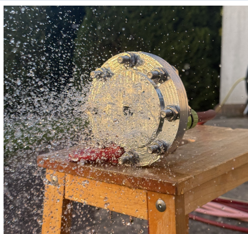
Test szczelności wtrysku po stronie utleniacza.
