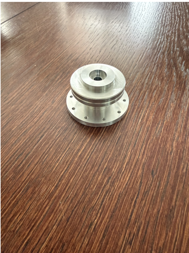
Element szybkozłącza wykonany na CNC.
