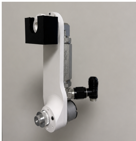
Część hydrauliki odpowiadająca za tankowanie - szybkozłącze, silnik zwalnający, zawór zwrotny
