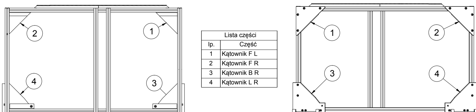
Rysunek 2 Rozmieszczenie profili i typy zastosowanych kątowników, Widok z góry i z dołu.
